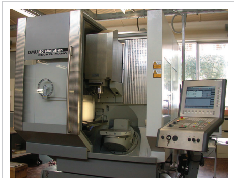
Centre d'usinage à broche verticale et deux plateaux tournants (5 axes) de Deckel
