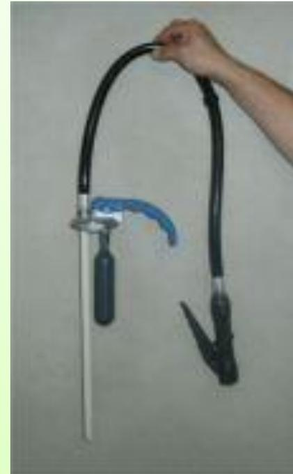
Une petite bouteille de CO<sub>2</sub> {sparklet} permet de mettre le produit sous pression.
